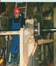
▲ Portées de paliers d'un concasseur
