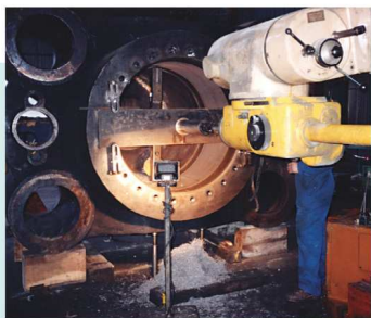
▲ Culasse de presse hydraulique
