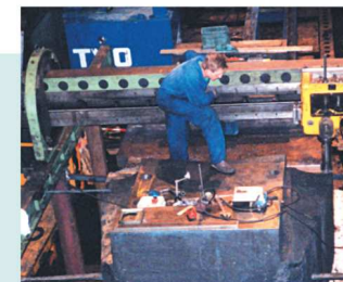
▲ Usinage complet d'une chabotte de marteau pilon 16 T
