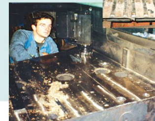
▲ Table de presse après rechargement
