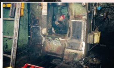
▲ Réparation Bâti de presse
