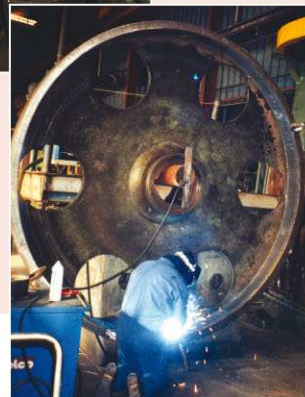
▲ Réparation d'un volant d'entraînement de presse WEINGARTEN
