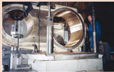
▲ Bielle à l'usinage
