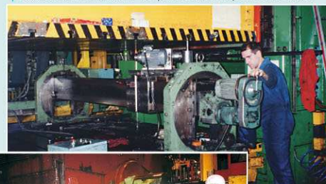
▼ Exécution de rainure en T sur presse de découpe en carrosserie
