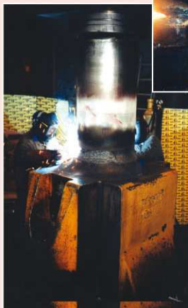
▲ Réparation d'un piston supérieur sur marteau BECHE
